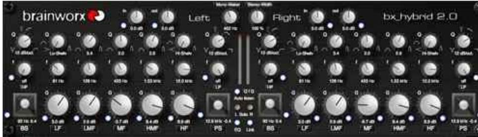
Die fünf Hauptbänder, oder Main Section, arbeiten vollparametrisch, es lassen sich Frequenz, Cut/Boost und die EQ-Güte regeln. Die 3 Mittenbänder sind als Peak-Filter ausgelegt, LF und HF lassen sich über den Q-Button jeweils auch als Shelving-Filter schalten. Jedes Frequenzband lässt sich individuell auf Bypass setzen, was im täglichen Betrieb eine enorme Erleichterung darstellt, z. B. im Vergleich zum Mischpult-EQ, der sich meist nur global aus dem Signalweg nehmen lässt.
